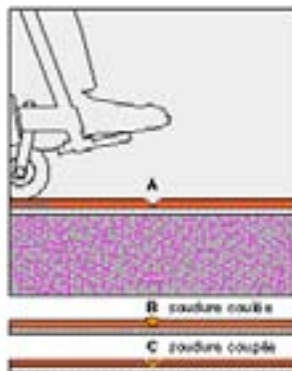
A - Coupure à 45° B - Soudure coulée à chaud C - Renflement de la soudure coupée
